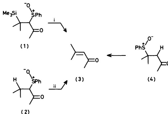
i, CCl<sub>4</sub>, 90 °C, *t*<sub>1</sub> 1.4 h; ii, CCl<sub>4</sub>, 90 °C, *t*<sub>1</sub> 4.6 h
